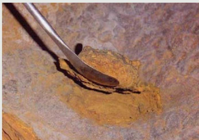
Figura 6 - Remoção da massa de tubérculos para coleta de amostras. Repare que, no fundo, a característica da superfície da tubulação é a mesma da figura 3.
