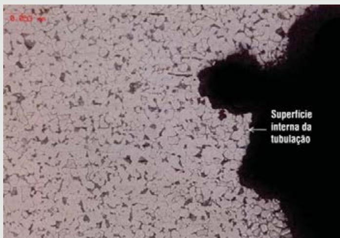
Figura 5 - Microestrutura típica do AC: ferrita e perlita. Note como se processaram os danos, a partir da seção interna da tubulação. Pites de todos os tamanhos.
