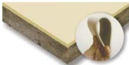
*MWM é a manta cimentícia impermeabilizante com 100% de memória, 100% flexível e com DNA polimérico. Substitui as tradicionais mantas asfálticas para qualquer tipo de aplicação. Resistente ao sol e até 70mca. Aceita movimentos da estrutura e pode ser aplicada em superfícies úmidas. Compatível com argamassas e concretos. É aplicada com trincha ou desempenadeira.*
