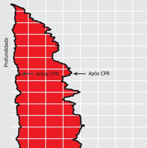
Melhoria da resistência do solo aferida por um CPT. solo com relação a futuros recalques. O recalque calculado na ponta do lápis é inversamente proporcional ao módulo do solo, tanto para o módulo elástico, E, como para o módulo confinado, M, que, por sua vez está associado à resistência obtida com o ensaio CPT, através da fórmula:
