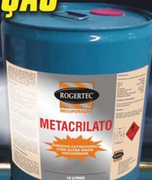
Com viscosidade igual a da água, o **METACRILATO** preenche e monolitiza qualquer trinca ou fissura existente em pisos e pavimentos com até 0,05mm de abertura. Basta verter o produto. O **METACRILATO** também monolitiza trincas e fissuras em vigas e pilares, de maneira fácil e rápida. É só fazer um pequeno furo na parte superior da peça e verter o produto com a ajuda de um pequeno funil. Não fique perdido no tempo das injeções.
