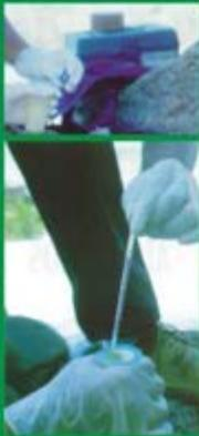
*Clor-test foi desenvolvido para analisar a contaminação em qualquer tipo de superfície. Seus componentes são pré-medidos, de modo a assegurar resultados precisos, em partes por milhão (ppm) e microgramas por centímetro quadrado (mgr/cm<sup>2</sup>), sem necessidade de qualquer correção em relação à temperatura ambiente. Em outras palavras, Clor-test é a precisão do laboratório na obra.*
