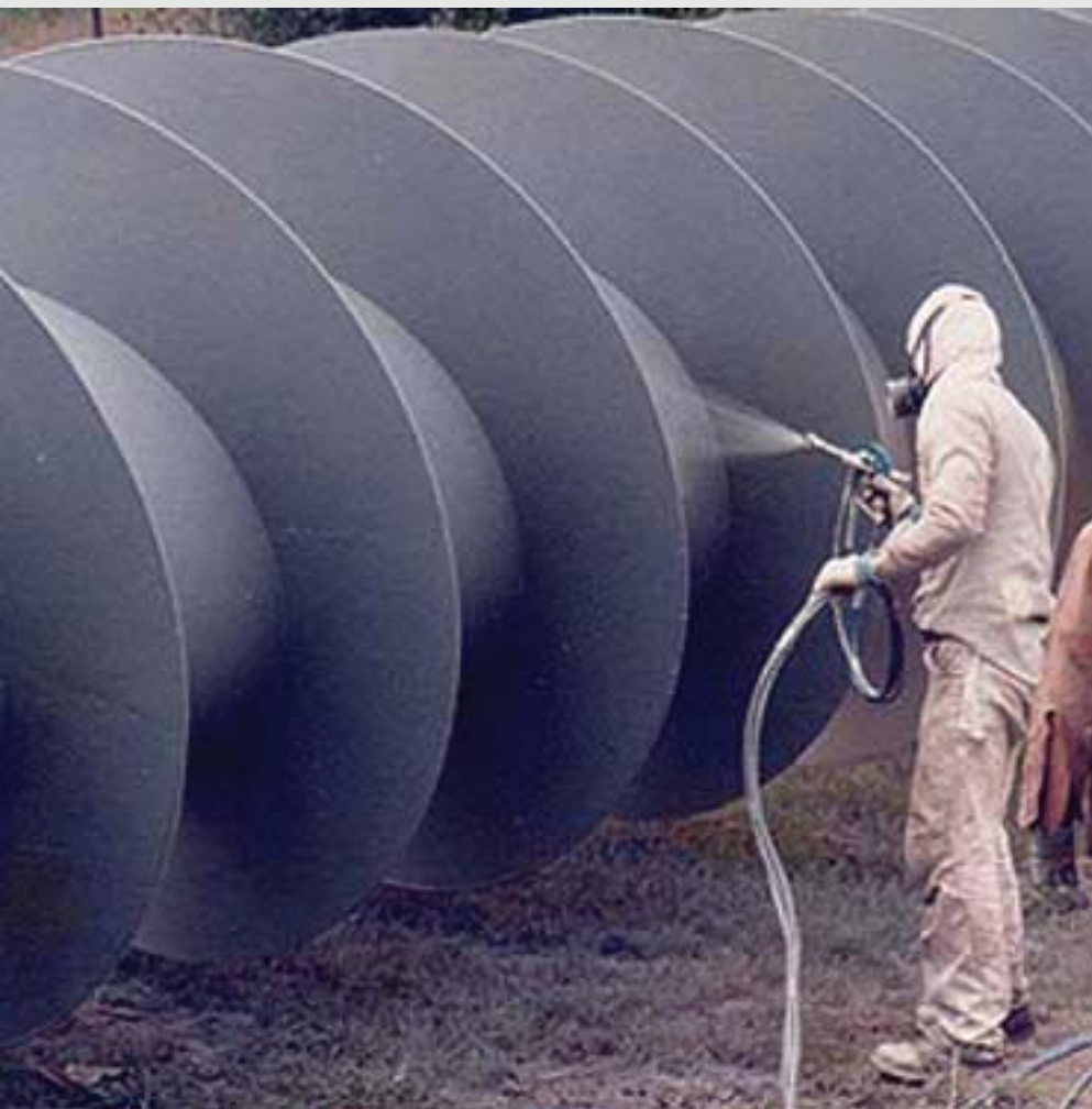
Epóxis novolacs respondem com o máximo de proteção contra ataques químicos e abrasivos.
