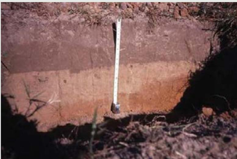
Várias camadas de um solo de fundação: resistências diferenciadas.
