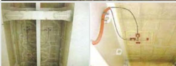
Extensômetros transversais e longitudinais, à base de cabos ópticos, sob o tabuleiro.
