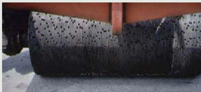
Um dos tipos de fresa para preparação do pavimento.
