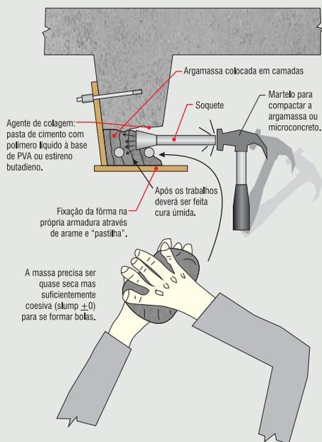
material deverá ser quase seco, de modo a não fazer água de exsudação ao ser comprimido dentro da cavidade, com utilização de soquete ou martelo. Um agente de colagem vai bem.
