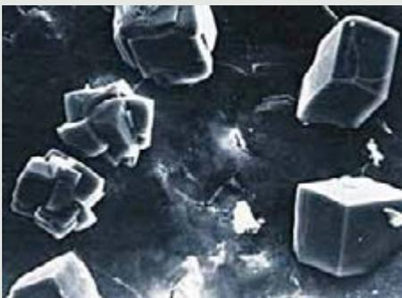
Panorama de um poro do concreto feito com microscopia eletrônica de varredura, antes da aplicação de um tratamento com cristalização.
