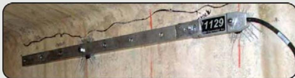
Sensor de cabo óptico posicionado no interior de viga-caixão.
