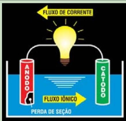
Simulação de uma pilha de corrosão.
