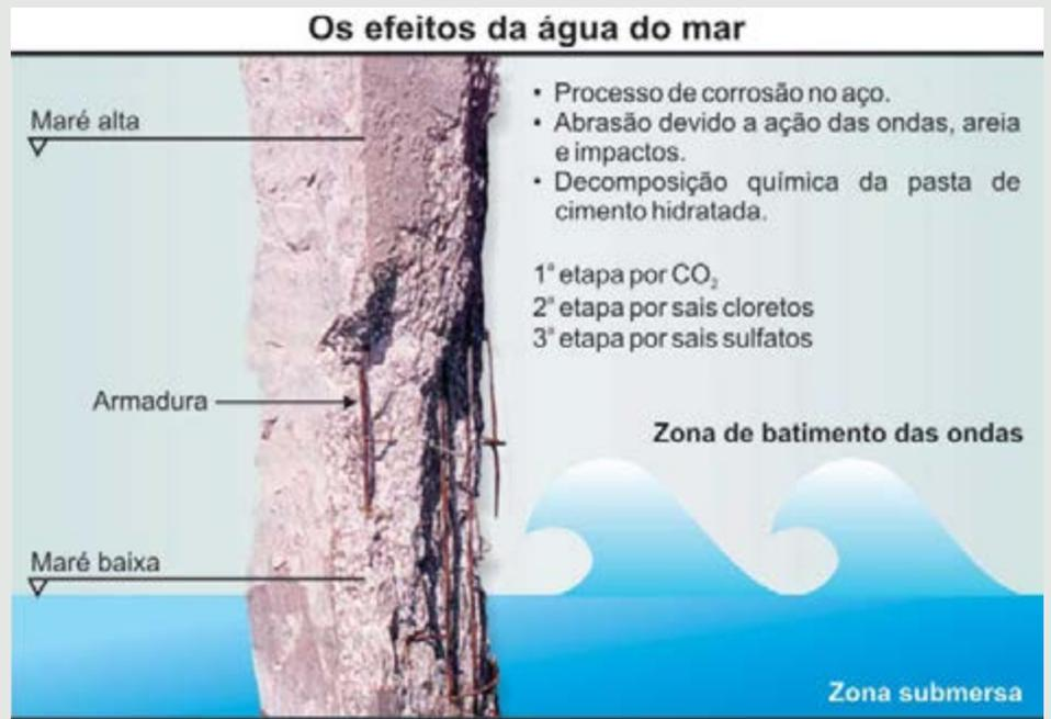
Estacas de concreto armado-protendido e o efeito do ataque químico e eletroquímico no concreto e armaduras.
