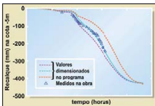
Evolução das deformações (recalques) durante a execução de um bulbo de CPR. A expansão do bulbo é controlada pelo critério de pressão máxima e/ou volume máximo bombeado, ambas pré-estabelecidas pelo programa.
