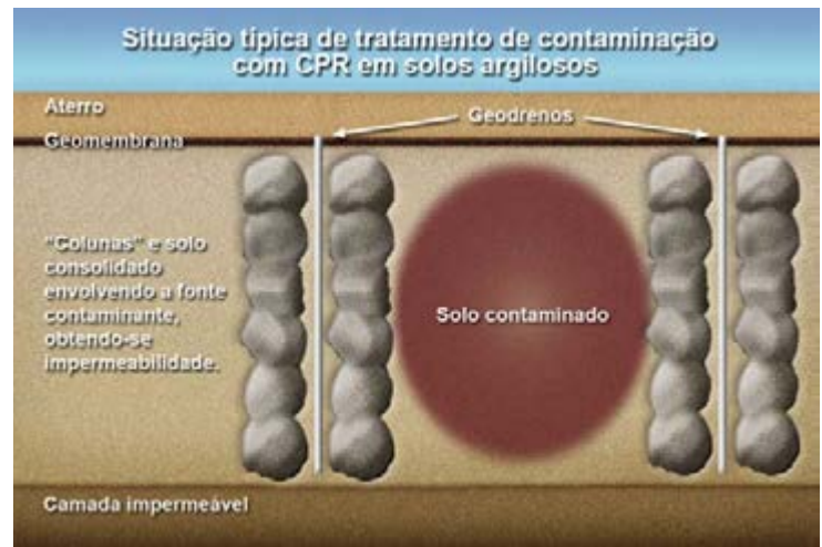
Tratamento de solo argiloso contaminado com Consolidação Profunda Radial (CPR). Devido à consolidação provocada, diminui consideravelmente a permeabilidade, confinando de forma segura, o solo contaminado.
