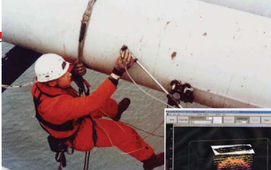
A utilização periódica de equipamentos de ultrassom associados a softwares específicos monitoram a corrosão em tubulações...
