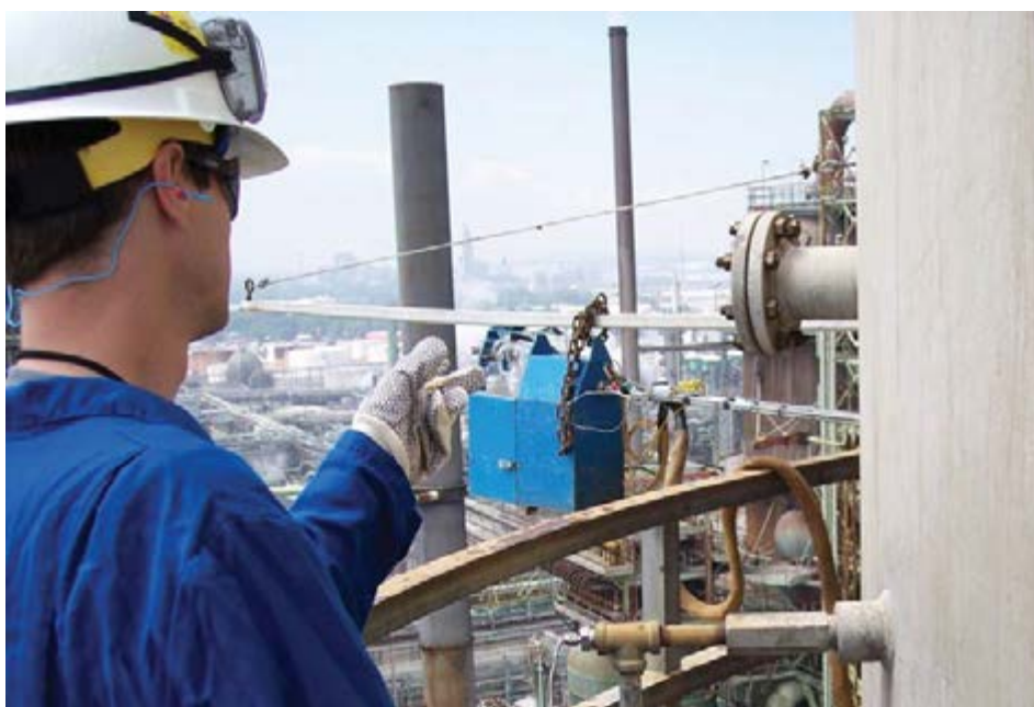
Equipamento para teste de emissão de fontes poluentes.
