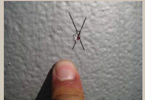
A preocupação com a espessura da película a ser aplicada é outra questão importante, ligada à durabilidade. Dependendo da espessura a ser utilizada você poderá utilizar o teste do corte em X (ASTM D-3359)
