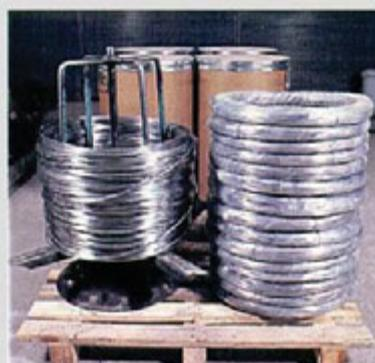
O FIO G é um sistema de proteção catódica à base de corrente galvânica, adequado para interromper ou impedir processos de corrosão em qualquer estrutura de concreto armado/protendido. O FIO G é eletricamente ligado às armaduras, tipicamente quando inexistente camada de recobrimento. Desta forma, todo e qualquer processo de corrosão é impedido de ocorrer nas armaduras, mesmo virtualmente sem camada de recobrimento.
