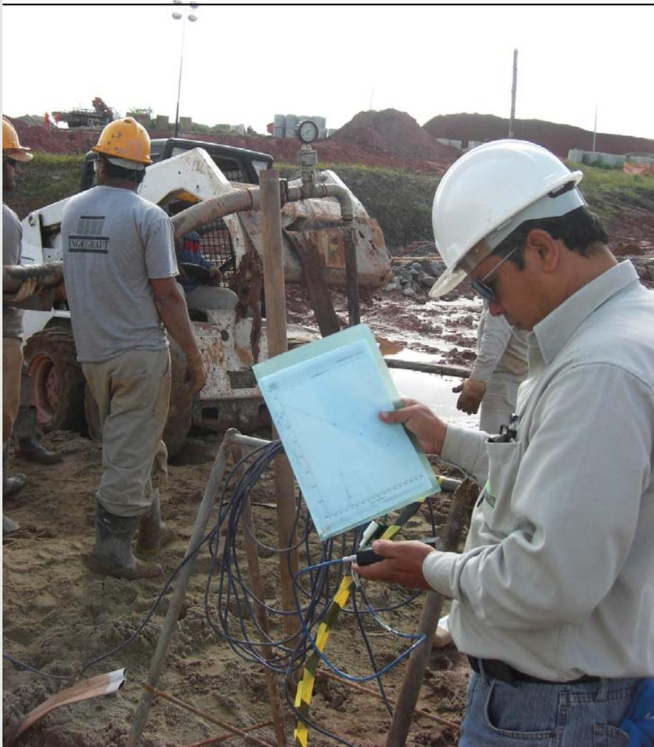
Análise da pressão neutra, através da leitura do piezômetro de cordas vibrantes, durante um serviço de CPR, para melhoramento de solo mole.
