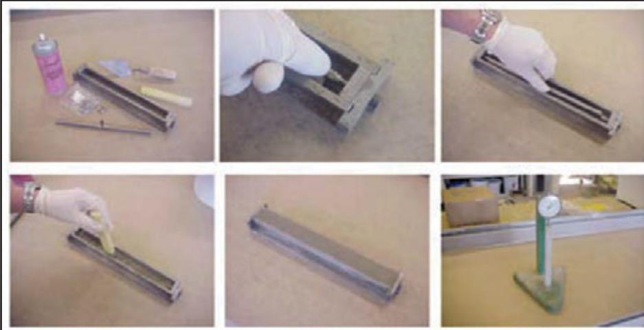
Acima e abaixo: ASTM C157, "Método padrão para determinação de alterações no comprimento de argamassas e concretos feitos com cimento portland.
