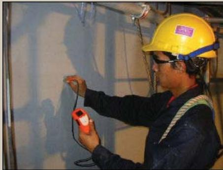
É muito importante checar, após a completa secagem da película, a espessura do filme seco, se está de acordo com o contratado. Há diversos equipamentos adequados para tal. Pesquise na RECUPERAR.
