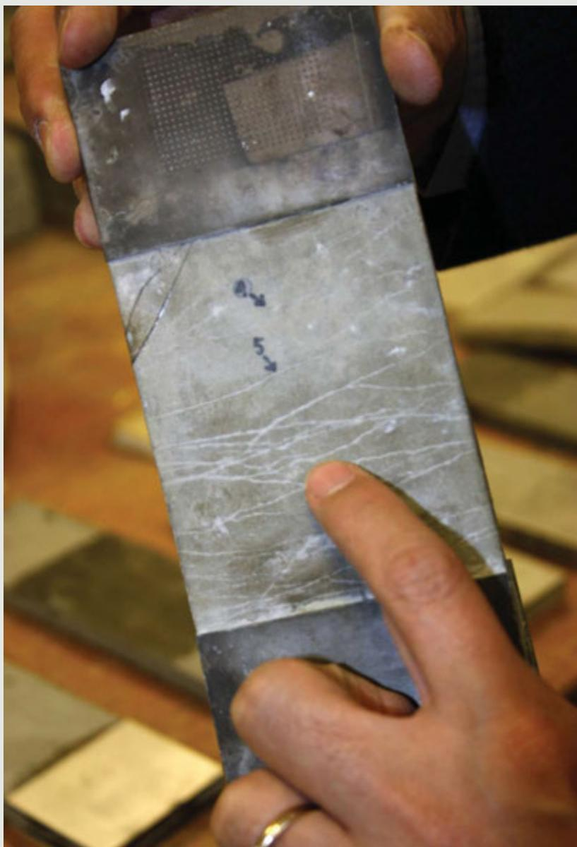
Linhas brancas no corpo de prova evidenciam onde o CCAR sofreu automonolitização, com formação de CaCO<sub>3</sub>. Este corpo de prova sofreu diversos ciclos de fissuramento com subsequentes processos de automonolitização, evidenciando resiliência necessária à atuação nas obras.
