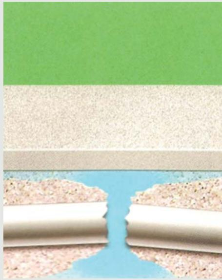
Figura 3 – Fontes indesejáveis d'água abaixo do piso: tubulações com vazamentos, bolsões d'água e nível freático extremamente alto...
