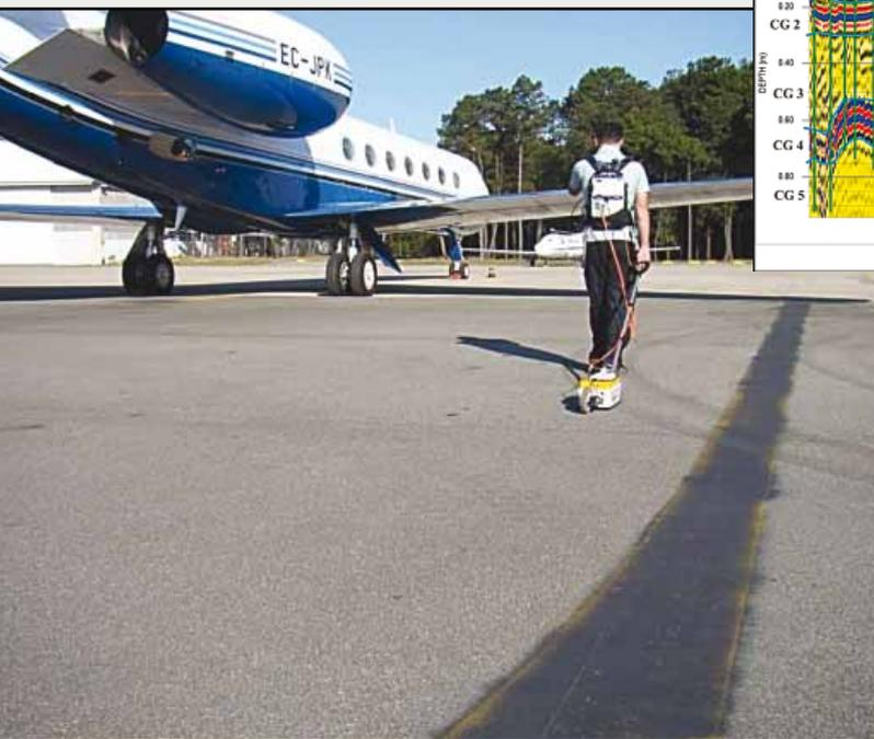
Levantamento com georadar (antena blindada de 800 MHz) para avaliação estrutural e estratigráfica em pavimento rígido e flexível.
