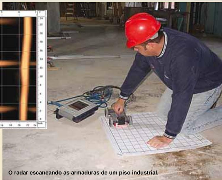
O radar escaneando as armaduras de um piso industrial.
