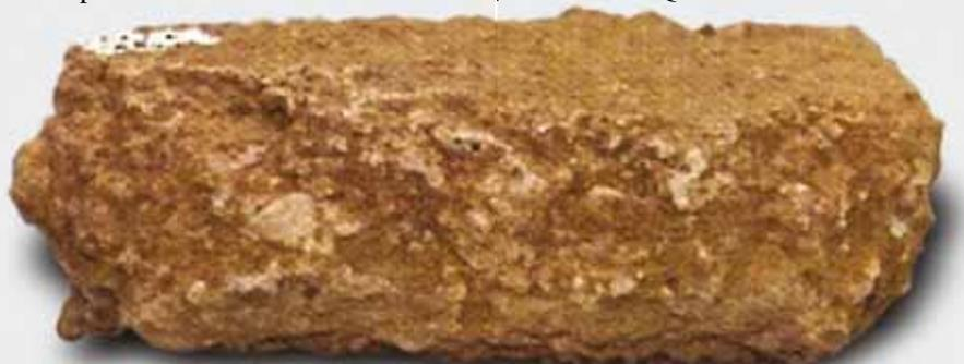
Figura 2 – Esta amostra de concreto evidencia, claramente, ingredientes típicos utilizados em qualquer concreto: agregados miúdos, graúdos, pasta de cimento e, reparem, vazios que induzem à existência de bolhas de ar.
