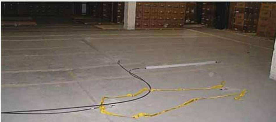
... e a instalação de cabos óticos no piso, antes do teste de carga.
