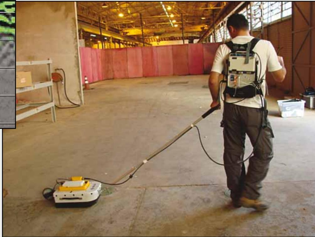
Deteção de dutos com antena blindada de 500MHz.
