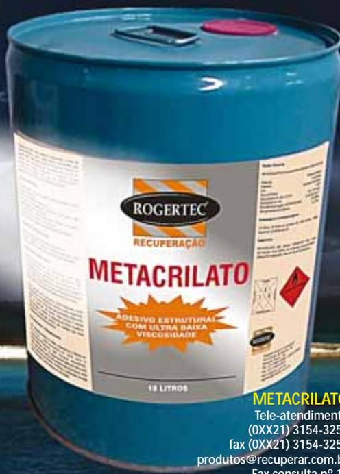
Com viscosidade igual a da água, o **METACRILATO** preenche e monolitiza qualquer trinca ou fissura existente em pisos e pavimentos com até 0,05mm de abertura. Basta verter o produto. O **METACRILATO** também monolitiza trincas e fissuras em vigas e pilares, de maneira fácil e rápida. É só fazer um pequeno furo na parte superior da peça e verter o produto com a ajuda de um pequeno funil. Não fique perdido no tempo das injeções.
